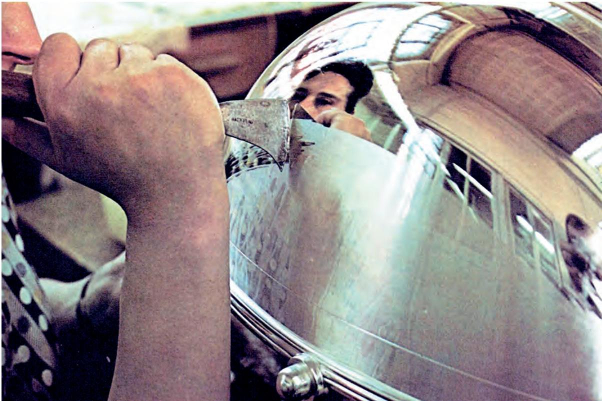
**Fig. 6** – Cloche à bœuf en argent en cours de brunissage. L'opération de brunissage dure vingt heures. Elle commence avec un brunissoir en acier et se termine avec un brunissoir en agate (Velter et Lamothe, 1978, p. 333).
